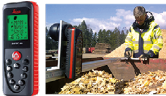
Kontroll av skäppmätning med laseravståndsmätare.
