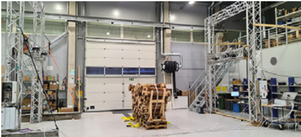
Teknikutveckling pågår. Lasermätstation för kontrollmätning av fordonstravar (foto Teknosavo).
